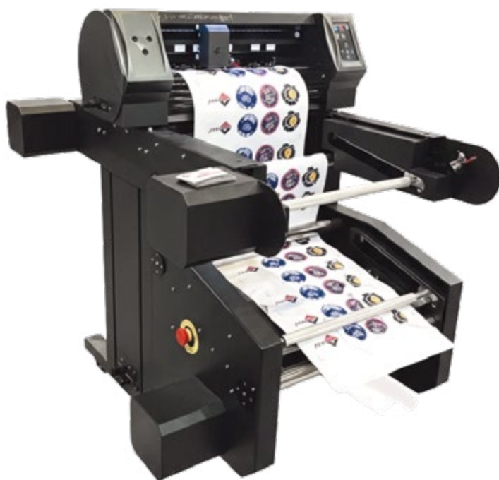
Вырубка на SkyCut JDJ 330 «с рулона на рулон» не только позволяет максимально расширить спектр услуг, но и поможет сэкономить деньги и пространство без установки еще одной секции для флексомашины
