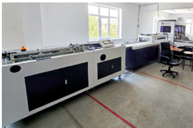
Автоматизированная линия по производству крышек PC-550P позволяет за смену сделать 12 тыс. крышек, при этом для ее обслуживания достаточно всего двух операторов.
