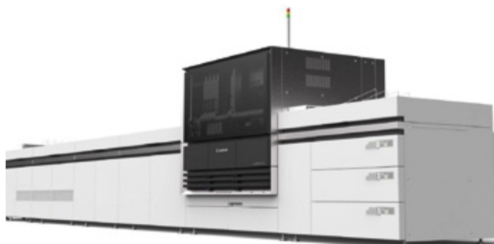
Высокоскоростные струйные ЦПМ HP и Canon i1700, работающие на термоголовках
