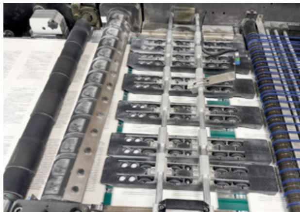
В струйных рулонных ЦПМ Atexco VegaPress для повышения производительности используются накопитель и автоматический роспуск на листы
