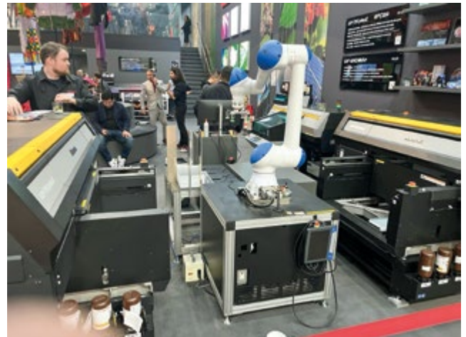
На drupa 2024 впервые показывали роботизированный комплекс Mimaki M2COA, обеспечивающий загрузку предметов для УФ-печати, выгрузку готовой продукции и обслуживающий сразу два принтера. Как утверждают разработчики, он способен снизить нагрузку на оператора на 90%
