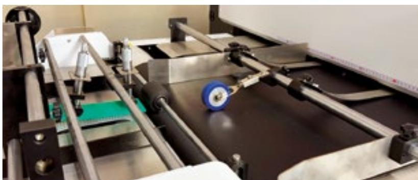
Автоматическая система загрузки устраняет необходимость ручной подачи каждого листа, что дает возможность печатать продукцию на максимальной скорости – до 40 погонных метров в минуту.
