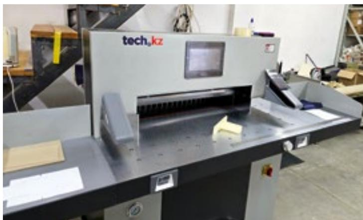
Гильотина 8008HT одинаково хорошо справляется как с подрезкой готовой продукции, так и с роспуском бумаги и переплетного картона.
