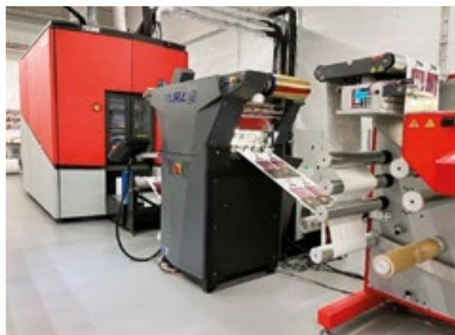
Xeikon TX500 с прототипом модуля металлизации от Kurz в линию в 2023 году
