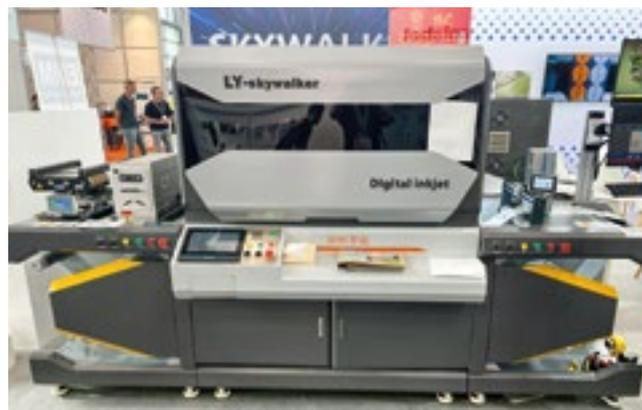
Одна из немногих машин для цифрового облагораживания, показанная на drupa 2024 китайским производителем SHM International, – узкорулонная LY350 наносит струйным способом белый, лак, а также включает модуль цифрового тиснения фольгой
