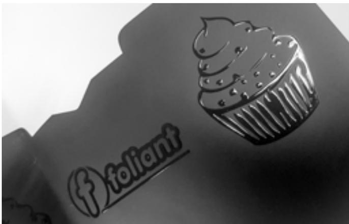
Благодаря модулю фольгирования 3D-лак и фольгирование получаются ничуть не хуже, чем у цифровых машин для постпечатной отделки, а «тяжелое» оборудование Foliant все чаще используется для цифрового облагораживания готовой продукции в сегменте упаковки.
