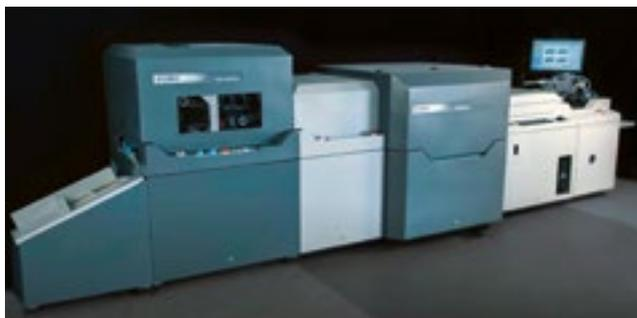
В ассортименте Komfi теперь есть полноценная система цифрового облагораживания с возможностью выборочного лакирования и тиснения фольгой за один прогон – Spot-matic 54 с модулем Spot-foiler 54
