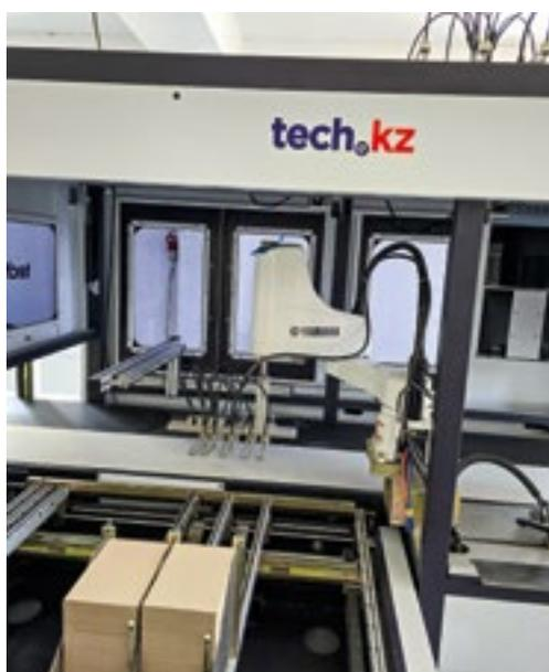
Благодаря манипулятору Yamaha, который входит в комплектацию РС-550Р, точность позиционирования составляет 1,1 мм.
