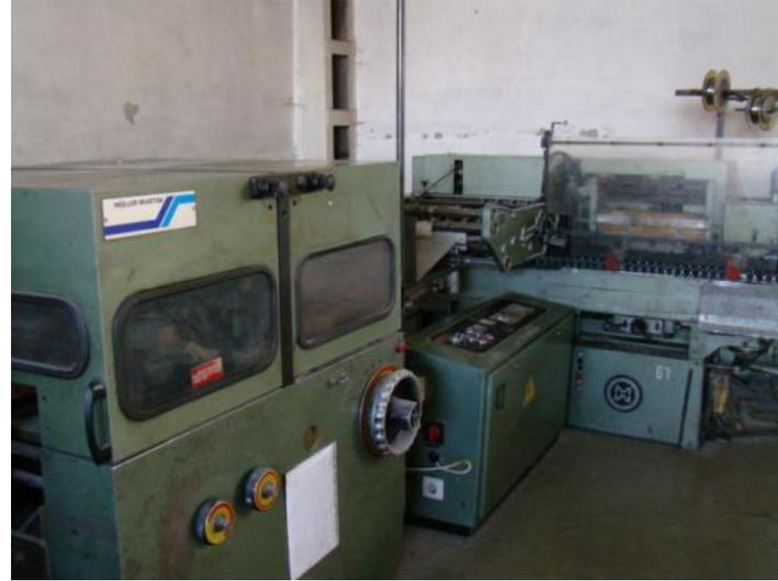
**Книжная линия для обработки книжного блока с интегрированной секцией подачи интегральной обложки Kolbus BF40**
