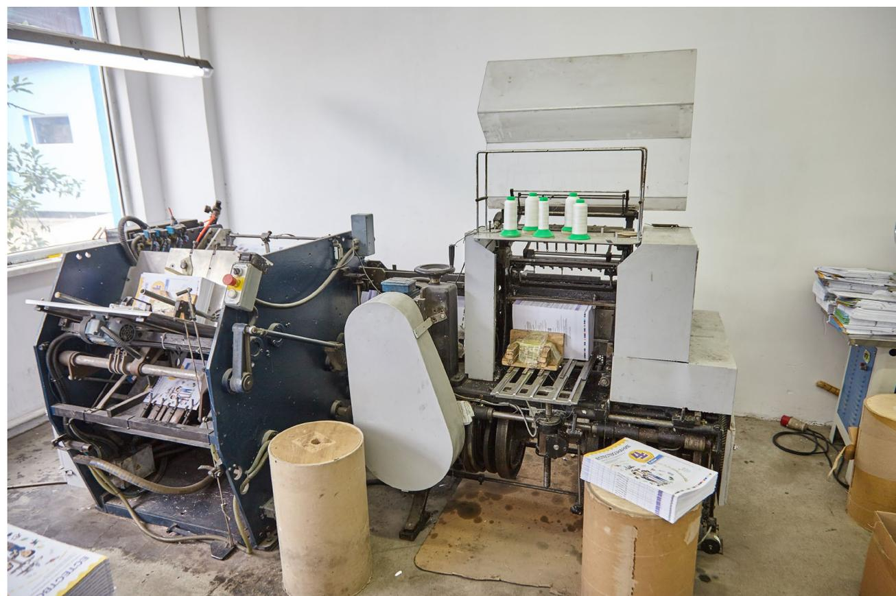
**Станок для снятия противоотмарывающего порошка LIXIN**
